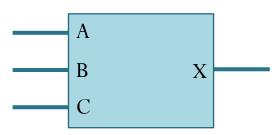
$$X = A\overline{B}C + \overline{A}BC + \overline{A}\overline{B}C + \overline{A}\overline{B}\overline{C} + A\overline{B}\overline{C}$$
